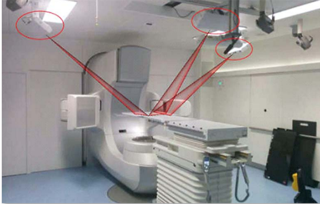
Schematische Darstellung der Infrarotlichtkegel, die die Oberfläche des Patienten anstrahlen. (Bild Firma Vision RT®)
