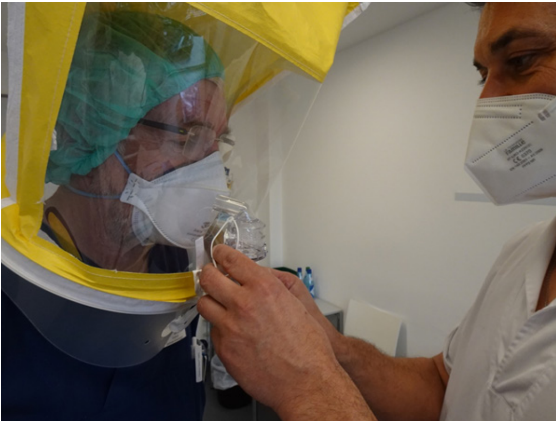
Abb. 1: Fit-Test. Verneblung einer wässrigen Zuckerlösung unter einer Haube.
