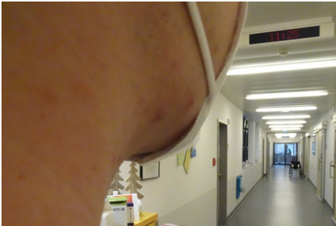
Abb. 2: Undichte Stellen am Kinn führen im Fit-Test zum sofortigen Erkennen der Zuckerlösung.
