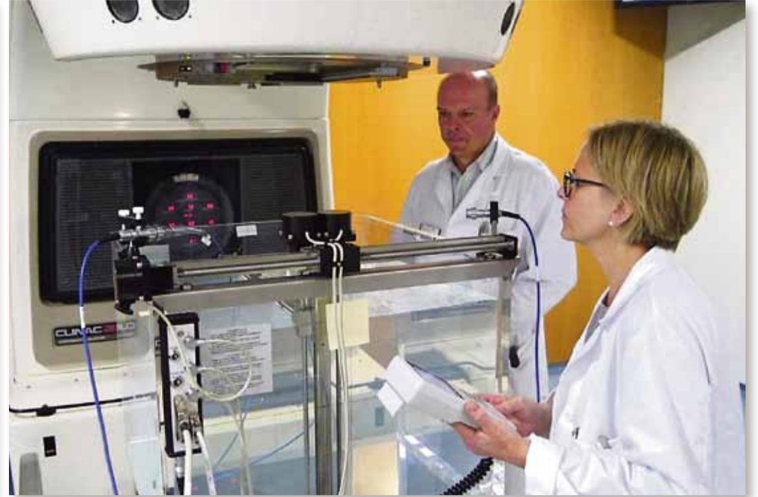
Dosiskalibrierung am Linearbeschleuniger - Ines Reng und Thomas Merz beim Einrichten des Wasserphantoms.
